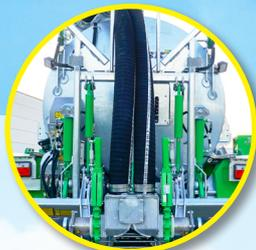
Anti-goteo hidráulico (sistema Twist)
